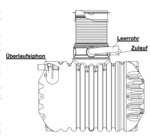
**Wichtig:** Das Leerrohr ist an einer Öffnung **oberhalb** des max. Wasserstandes anzuschließen. Um eine Be- bzw. Entlüftung des Behälters zu schaffen ist ggf. ein DN 100 KG - Rohr an einer freien Öffnung anzuschließen und steigend zur Entlüftungsstelle zu verlegen. Der Zusammenschluss mit Entlüftungen anderer Bauwerke ist nicht zulässig.
