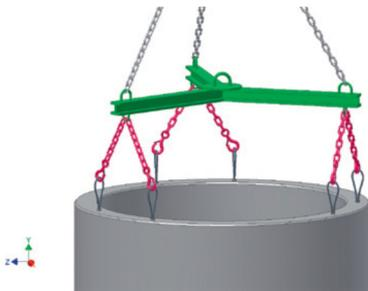
Behälter mit hohen Einzelgewichten, insbesondere durch Einbauten, sind nicht mit 3 (4), sondern mit 6 (8) Versetzankerhülsen auf der Behälteroberseite ausgestattet („Doppelanker“). Behälter dürfen nur mit zusätzlichen Anschlagmitteln eingehoben werden!
