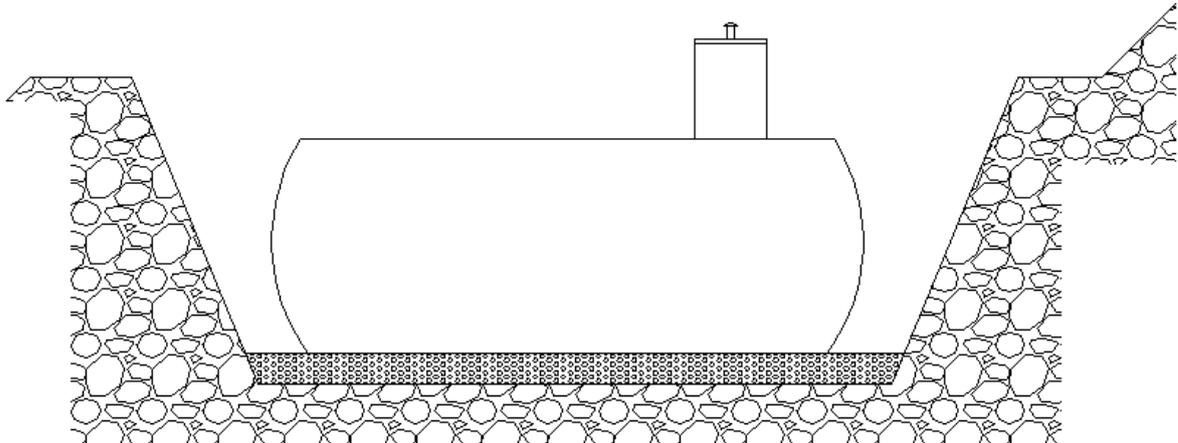
Diese zusätzlichen Belastungen müssen mittels Stützmauern, Piloten oder Lawinverbauungen etc. vom Behälter ferngehalten werden. Bei der Verlegung des Speichers ist ein Mindestabstand quer zum Hang einzuhalten (Speicherdurchmesser + 75 cm).
