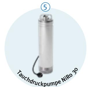
**Lieferumfang:** ① Monolithischer Erdtank der Serie CRISTALL® oder COLUMBUS ② Tankabdeckung Teleskop-Domschacht CRISTALL® oder COLUMBUS, ③ Deckel begehbar oder Teleskop-Domschacht Guss Pkw-befahrbar, ④ Filterkorb zum Einhängen in den Tank, Maschenweite 0,35 mm, ⑤ Edelstahl Tauchdruckpumpe mit Start-Stop-Automatik (max. 3,2 bar, Fördermenge 5100 l/h, Motorleistung 0,85 kW), ⑥ Wassersteckdose Perfecta (vorbereitet für handelsübliche Schlauchkupplung, Seite 49), ⑦ 10 m Druckschlauch 1“
