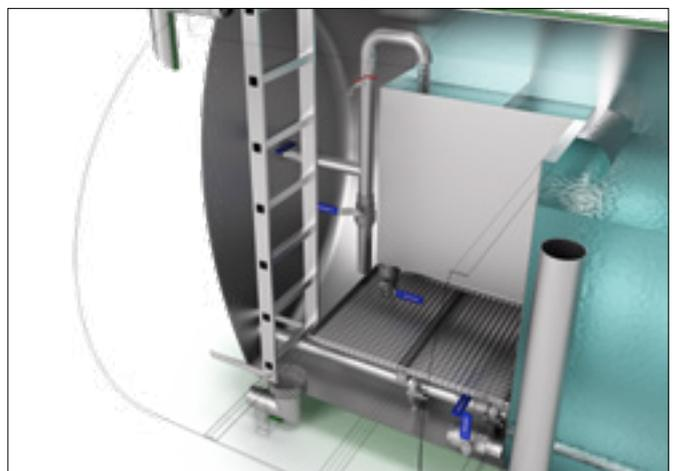
Detailansicht Tank mit integrierter Quellstube
