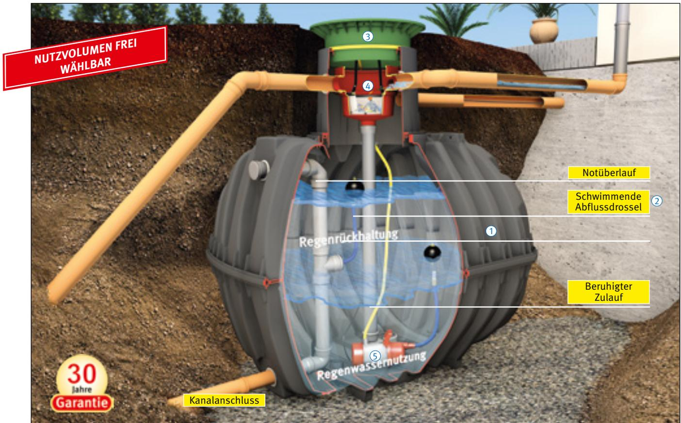
Abbildung zeigt Carat Retentionszisterne Plus mit schwimmender Abflussdrossel 0,05 bis 2,0 l/Sek. Größere Ablaufmengen auf Anfrage.
