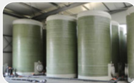
Lagerbehälter aus GFK für verschiedene Flüssigkeiten
