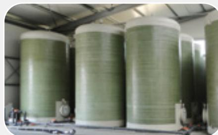
Lagerbehälter aus GFK für verschiedene Flüssigkeiten
