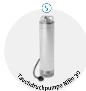
**Lieferumfang:** ① Monolithischer Erdtank der Serie CRISTALL® oder COLUMBUS ② Tankabdeckung Teleskop-Domschacht CRISTALL® oder COLUMBUS, ③ Deckel begehbar oder Teleskop-Domschacht Pkw-befahrbar, ④ Filterkorb zum Einhängen in den Tank, Maschenweite 0,35 mm, ⑤ Edelstahl Tauchdruckpumpe mit Start-Stop-Automatik (max. 3,2 bar, Fördermenge 5100 l/h, Motorleistung 0,85 kW), ⑥ Wassersteckdose Extern (vorbereitet für handelsübliche Schlauchkupplung, Seite 51), ⑦ 10 m Druckschlauch 1“
