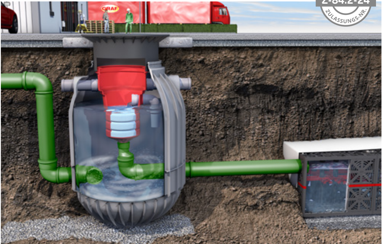
Abbildung zeigt EcoPure 200 Substratfilter mit Teleskop-Domschacht 600 Guss und nachgeschalteter Versickerungsanlage (Zubehör Seite 84)
