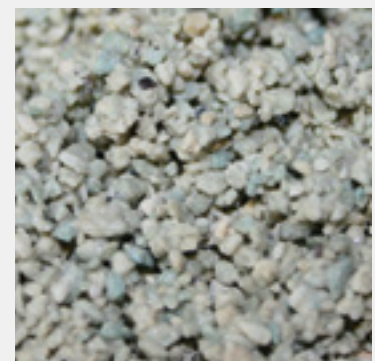
Filtersubstrat gem. ÖWAV Regelblatt 45 und Ö-Norm B2506-3
