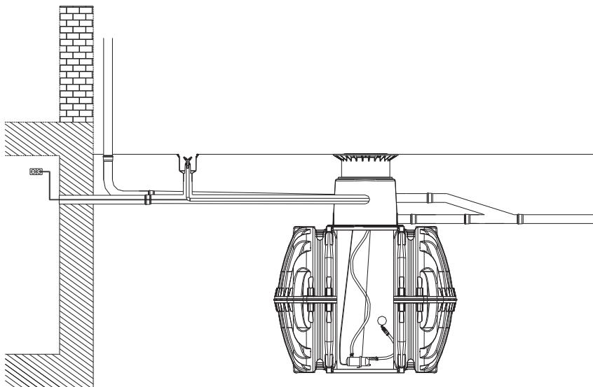
**Achtung:** Der Abstand zwischen Wassersteckdose und Erdtank ist durch die Länge des Druckschlauches begrenzt – Länge 10 m.
