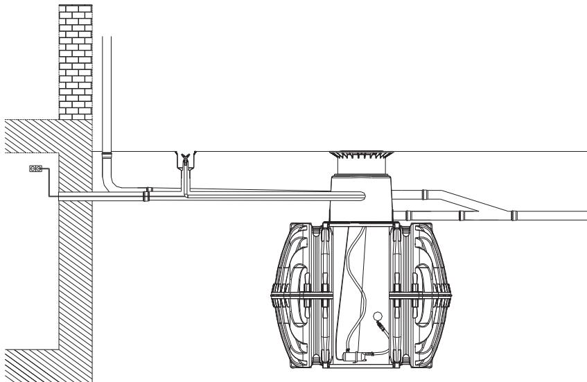
**Atención:** La distancia entre la arqueta de conexión de agua y el tanque subterráneo se encuentra limitada por el largo de la manguera de presión – largo 10 m.
