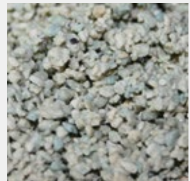
Filtersubstrat gem. ÖWAV Regelblatt 45 und Ö-Norm B2506-3
