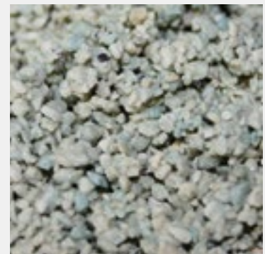
Filtersubstrat gem. ÖWAV Regelblatt 45 und Ö-Norm B2506-3
