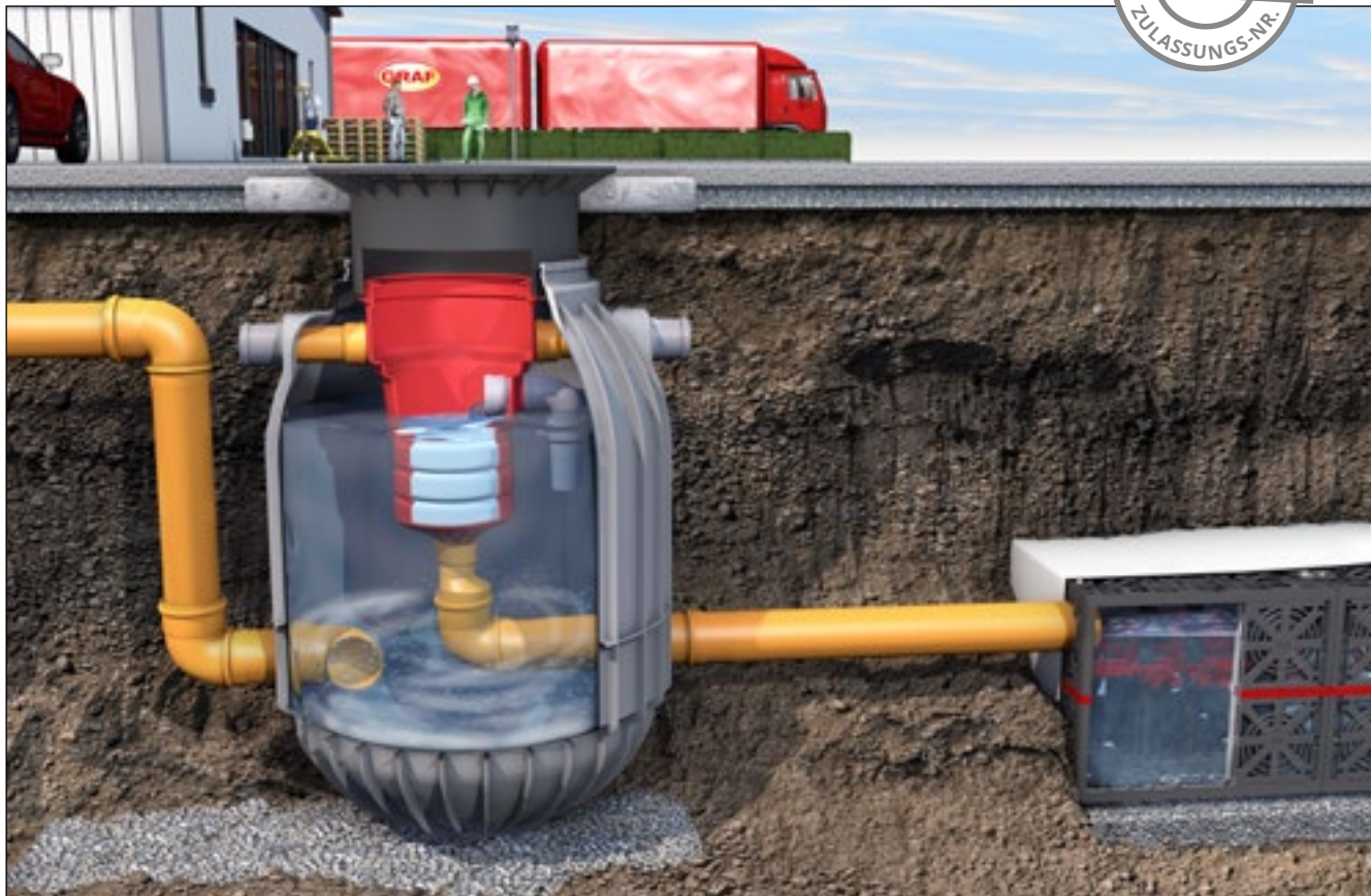
Abbildung zeigt EcoPure 200 Substratfilter mit Teleskop-Domschacht PKW und nachgeschalteter Versickerungsanlage (Zubehör S. 142)
