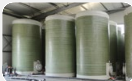
Lagerbehälter aus GFK für verschiedene Flüssigkeiten
