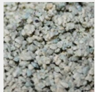
Filtersubstrat gem. ÖWAV Regelblatt 45 und Ö-Norm B2506-3
