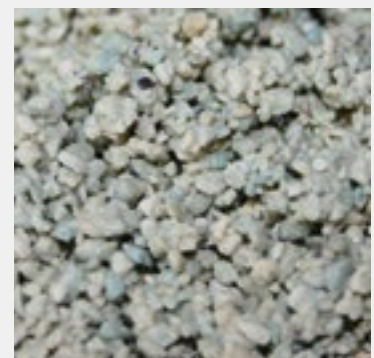
Filtersubstrat gem. ÖWAV Regelblatt 45 und Ö-Norm B2506-3
