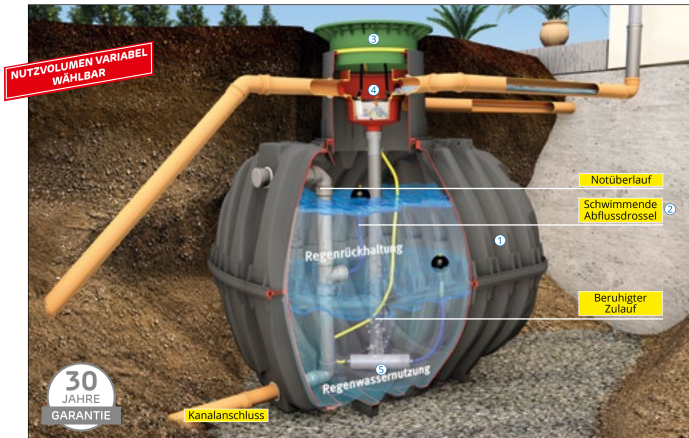
Abbildung zeigt Carat Retentionszisterne Plus mit schwimmender Abflussdrossel 0,05 bis 2,0 l/Sek. Größere Ablaufmengen auf Anfrage.
