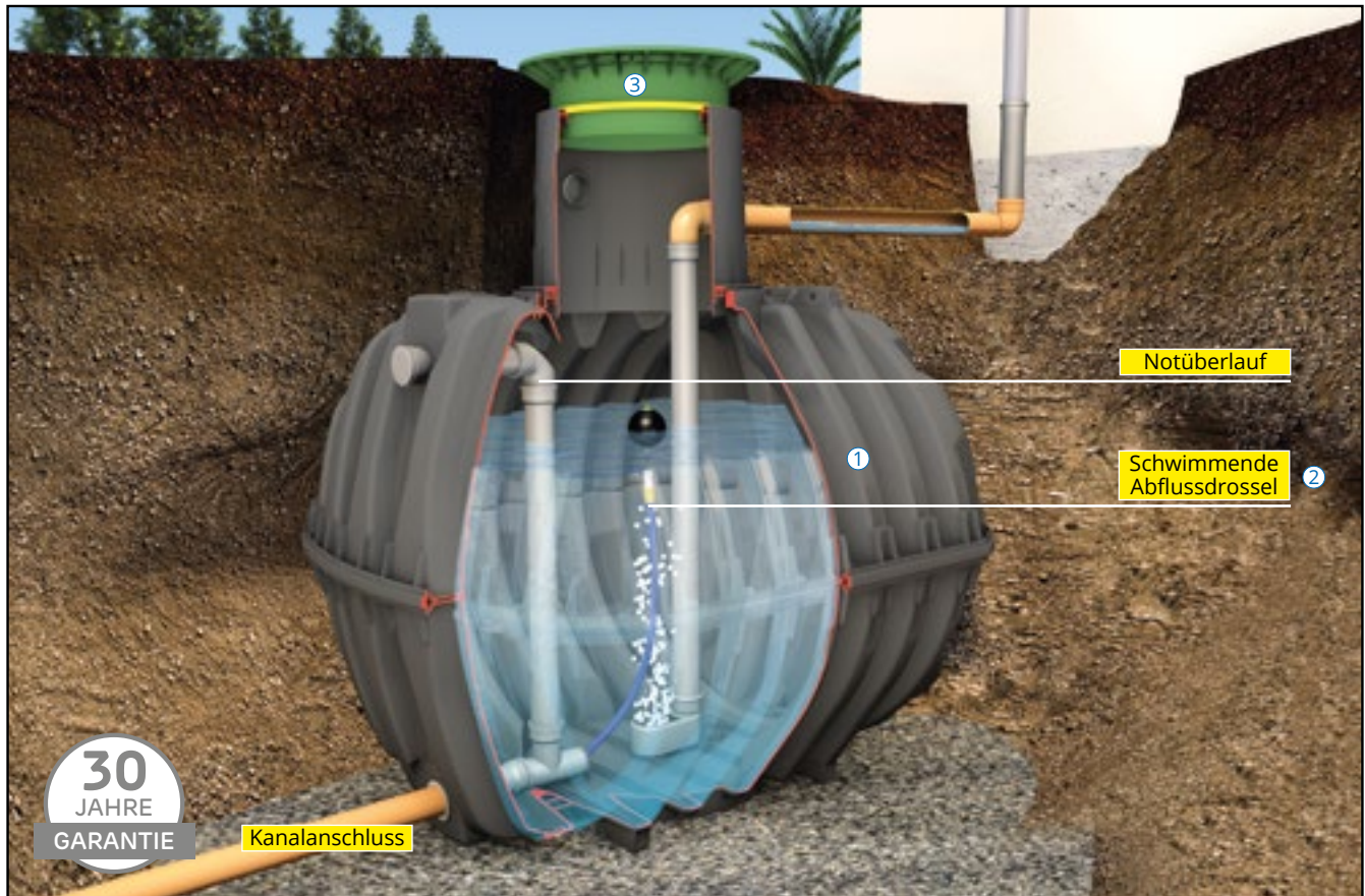
Abbildung zeigt Carat Retentionszisterne mit schwimmender Abflussdrossel 0,05 bis 2,0 l/Sek. Größere Ablaufmengen auf Anfrage.
