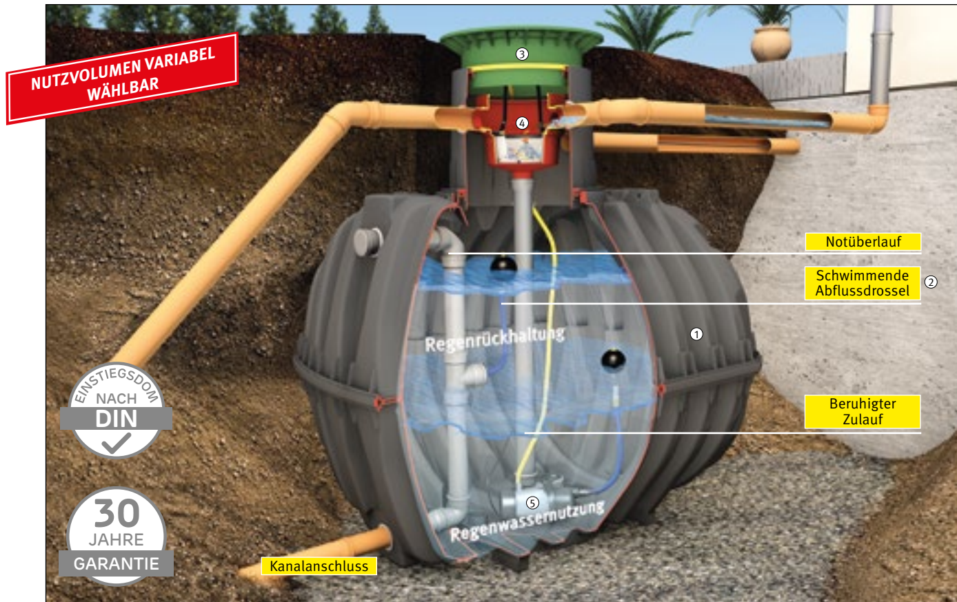
Abbildung zeigt Carat Retentionszisterne Plus mit schwimmender Abflussschleuse 0,05 bis 2,0 l/Sek. Größere Ablaufmengen auf Anfrage.
